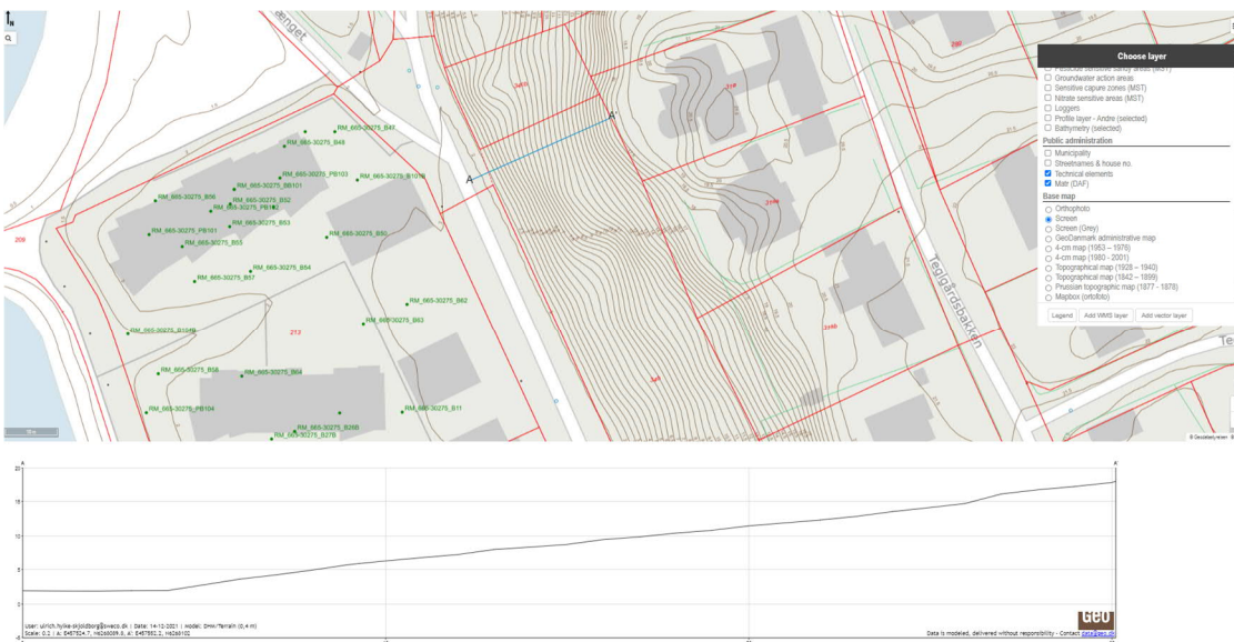
Figur 111: Skråningen ca. ved st.0+520. Strækningen A til A' er vist med blå linje. Der er ca. 15,5 meter terrænforskel over 26 meter.
