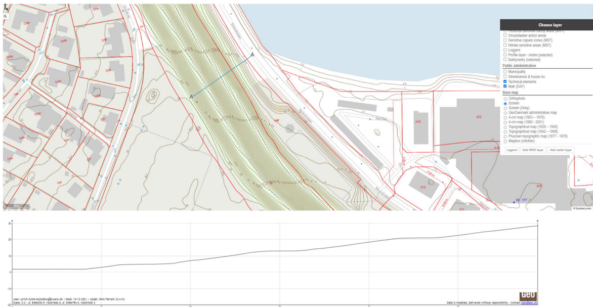
Figur 112: Skråningen ca. ved st.1+800. Strækningen A til A' er vist med blå linje. Der er ca. 26,5 meter terrænforskel over 59 meter. Der er lokaliseret 2 jernbanespor midt på skråningen.
